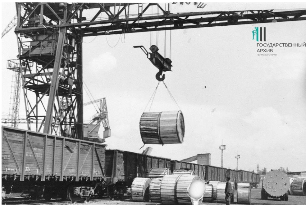
Погрузка готовой продукции в железнодорожные вагоны на товарной площадке завода Камкабель. 1969 г.
